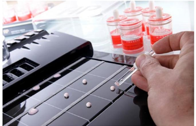
Abb. 1 Korrektur durch Anschichten eines Defekts.
